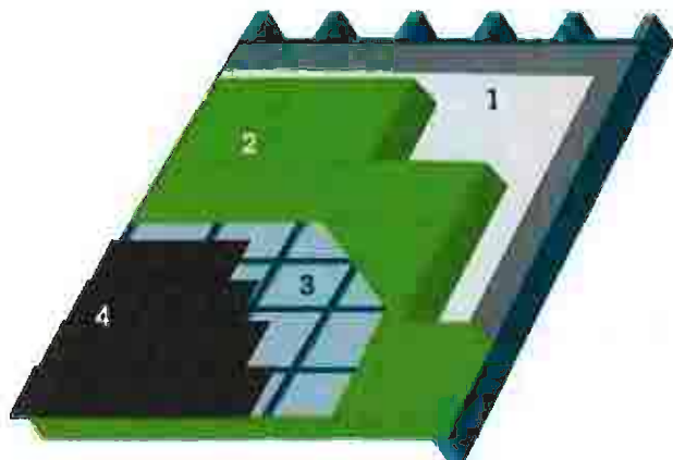
1. Dampscherm | 2. Isolatie | 3. Onderdak | 4. Dakbekleding
